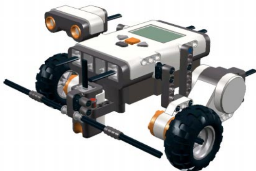
Рис. 11. Ультразвуковой датчик для поиска кеглей и модифицированный бампер
